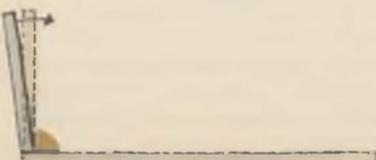
■ **Double soudure d'angle** : la tôle horizontale sera préalablement déformée avant soudage. Elle se redressera au refroidissement.
