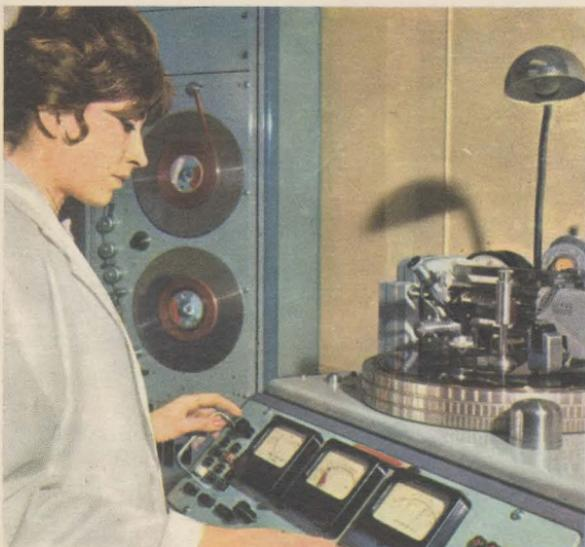
Elle consiste à transposer l'œuvre enregistrée sous forme de bande magnétique sur un premier disque qui est obtenu par une méthode approximativement inverse de la lecture d'un disque sur l'appareillage d'écoute.
