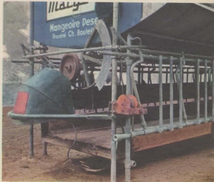
Type de convoyeur à vis d'Archimède.
